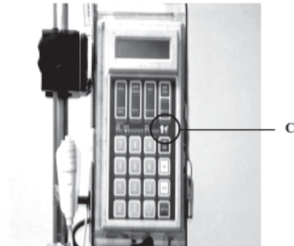
รูปที่ 5 แสดงตำแหน่งสัญลักษณ์ปลั๊กไฟติด จะมีแสงสีส้มปรากฏขึ้น เมื่อมีกระแสไฟเข้าตัวเครื่อง
