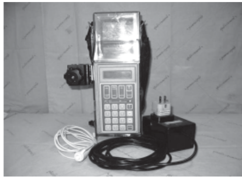
รูปที่ 2 แสดงส่วนประกอบอุปกรณ์เครื่อง PCA รุ่น Abbott pain management Provider
