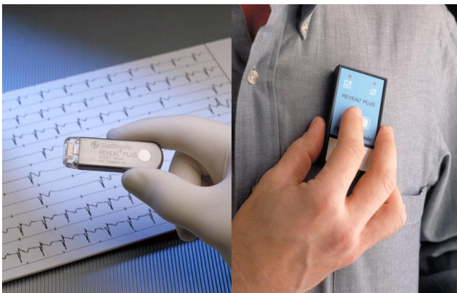
รูปที่ 4. เครื่องตรวจคลื่นไฟฟ้าหัวใจแบบพกพา ชนิดฝัง (Implantable Loop recorder) มีขนาดเล็ก อายุการใช้งานนาน เหมาะกับผู้ป่วยเป็นลมโดยไม่ทราบสาเหตุแต่อาการไม่บ่อย เพื่อการหาความสัมพันธ์ของอาการเป็นลมและการเต้นของหัวใจที่ผิดปกติ (ภาพด้วยความเอื้อเฟื้อจาก Medtronic, Thailand)
